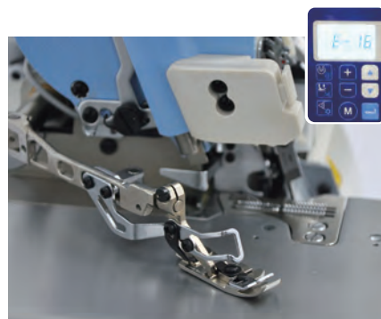
3. 带开闭感应的压脚抬升支架
