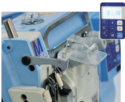
1. 带开闭感应目视挡板
