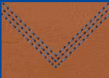
缝纫速度2,800sti/min、针码4mm
